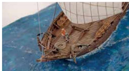
sul quale si ergeva una struttura rettangolare a telaio, il Posticcio o Aposticcio. Lo scafo delle Galee era dunque realizzato in modo da ottenere la massima velocità sotto la spinta dei remi; piuttosto basse di bordo, queste navi erano manovriere, ma poco adatte ad affrontare mare mosso.
